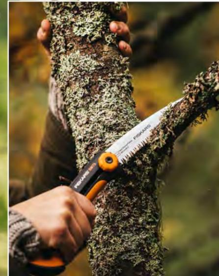
Dickere Äste ab rund 4 cm Durchmesser sind ein Fall für die Säge. Schwertsägen mit grober Zahnung (hier die Fiskars Handsäge Xtract SW73) eignen sich gut für frisches Holz. Klappbare Modelle erleichtern die Arbeit an beengten Stellen und lassen sich sicher transportieren. Wichtig: Arbeiten Sie mit Schwertsägen immer auf Zug und schieben Sie das Blatt ohne Druck zurück
