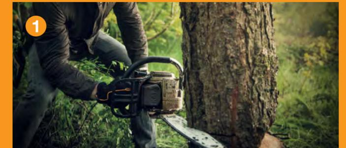
**1** In die Richtung, in die der Baum fallen soll, wird ein Fallkerb geschnitten. Er durchtrennt maximal ein Drittel des Stamms. Dann folgt der Fällschnitt, der den Baum aber nicht komplett durchtrennt, sondern eine schmale Bruchleiste stehen lässt, über die der Baum wie ein Scharnier in die gewünschte
