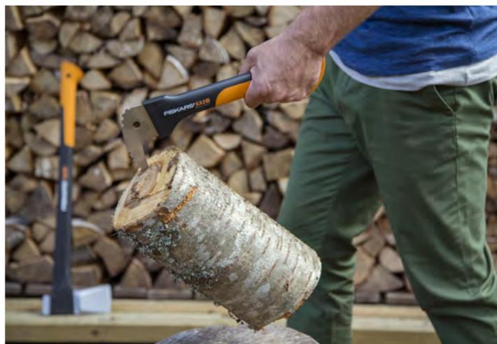
Der Sappie ist ein wenig bekanntes, aber sehr praktisches Werkzeug, um Holz zu transportieren. Beim Spalten muss man ständig neue Holzstücke holen und große Scheite zum weiteren Zerkleinern wieder auf den Klotz stellen – genau dabei bewährt sich der Sappie, den man mit wenig Kraft ins Holz schlägt, wobei man sich nicht tief bücken muss
