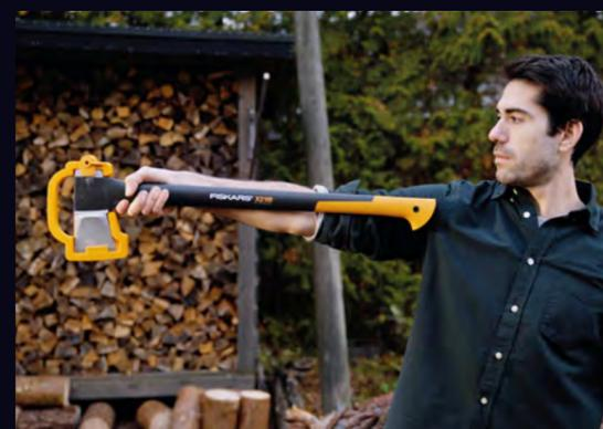
Auf die Länge kommt es an: Um ergonomisch optimal arbeiten zu können, sollten Axt- und Körpergröße zueinander passen. Halten Sie dazu die Axt unterhalb des Kopfes am ausgestreckten Arm. Der Stiel sollte in etwa bis zur Achsel reichen und weder deutlich kürzer noch länger sein
